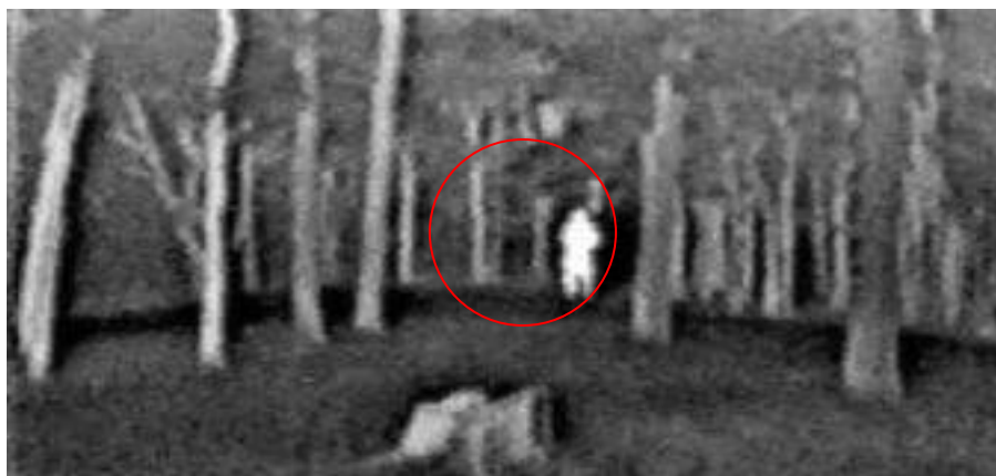
Рис. 2 – Видеоизображение с тепловизора – нарушитель ясно виден при полном отсутствии освещения.
